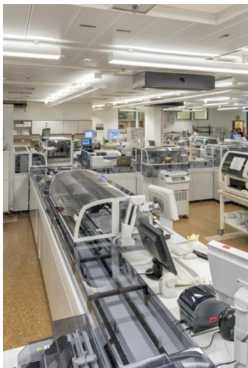
Abbildung 3: Automatisationsstraße des Zentrallabors des Universitätsklinikums Tübingen.
