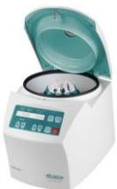
1. Zentrifugation: bei 300g / 1200rpm / 4°C / 10min → Sedimentation fester Bestandteile
